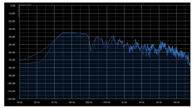
En la figura 9 existe un Roll-off a partir de 100 hz que se extiende hasta los 10hz presentando una atenuación máxima de 50 dB aproximadamente. Por otro lado, en la figura 10, la atenuación máxima en la misma frecuencia es de 70 dB.
