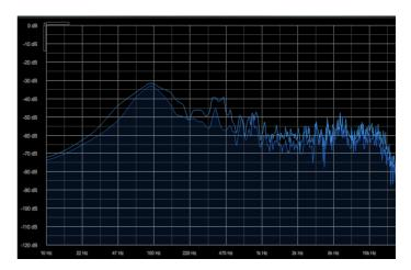
En la figura 5 existe un Roll-off a partir de los 100 hz hasta los 10hz, en donde existe una atenuación de 60 dB. En la figura 2, también existe un Roll-off en el mismo rango de frecuencias, pero este llega a atenuar 70 dB en 10 hz.
