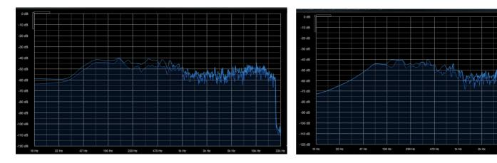
La figura 1 presenta mayor cantidad de frecuencias graves que la figura 2. Por ejemplo se observa que en la figura 1, 22 Hz tiene una atenuación de 60 dB; mientras que en la figura 2, la misma frecuencia tiene una atenuación de 65 dB.
